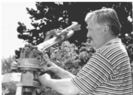
Réglez le secteur au canon (environ 220° pour toute la largeur de bande). Pour d'autres indications, veuillez voir les propres instructions de service du canon. Le WINDGUN peut être ajusté aux conditions de vent momentanées en réglant l'angle d'élévation du jet.
