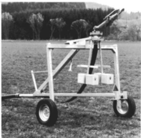
La haute construction des traîneaux à roues symétriques et asymétriques et des traîneaux à patins est particulièrement favorable aux cultures (les traîneaux asymétriques et à patins sont des options) La largeur de voie est réglable en continu et permet une adaptation à de différentes lignes de culture.
