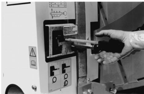
2. Tirez le levier d'arrêt en position d'arrêt et **relâchez le tube PE** en le pressant lentement et avec ...
