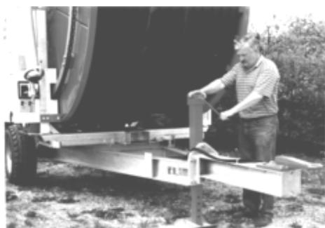
Installez le châssis à peu près horizontalement à l'aide de la béquille support sur timon.
