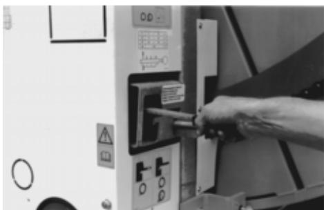
...et relâchez le tube PE en pressant lentement et avec précaution le levier d'arrêt vers le bas.
