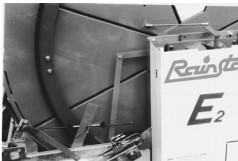
...et grâce à la tige de réglage montée directement sur la turbine. Les deux, le palpeur et la tige de réglage, actionnent une came de réglage que, par conséquent, réajuste la vitesse de la turbine
