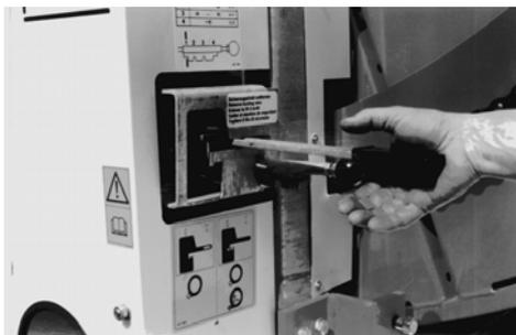
Au cas d'un incident imprévu, l'enroulement du tube peut être interrompu par l'arrêt rapide. En l'actionnant avec la main ouverte, le levier d'arrêt est tiré de la position „enroulement du tube PE“ à la position d'arrêt (N'actionnez pas le levier de commande avec la main fermée ou lâchez-le immédiatement!). L'engrenage est débrayé.
