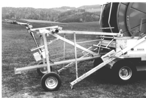
En descendant les béquilles, le traîneau est abaissé automatiquement en position „déroulement du tube PE“.
