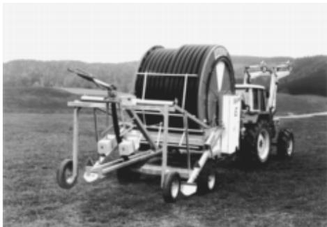
Pendant le transport, le tambour doit être tourné dans le sens de marche et être bloqué par la goupille. Le traîneau, la béquille support sur timon ainsi que les deux béquilles arrières doivent être levés. Placez le Rainstar au bord du champ à angle droit par rapport à la bande d'arrosage prévue et dételez-le du tracteur.
