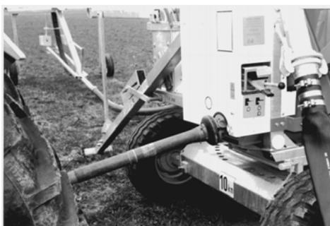
Si nécessaire, le tube PE peut également être enroulé par un tracteur par l'intermédiaire d'un arbre articulé.
