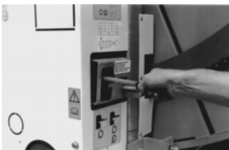
Relâchez le tube en pressant le levier de commande vers le bas lentement et avec précaution.
