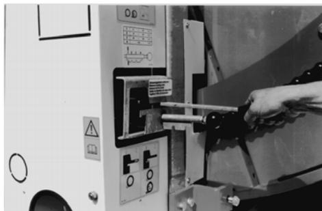
Lorsque la pression de service est atteinte et que de l'eau pure sort du canon en plein jet, mettez le levier d'engrenage en position „enroulement du tube PE“
