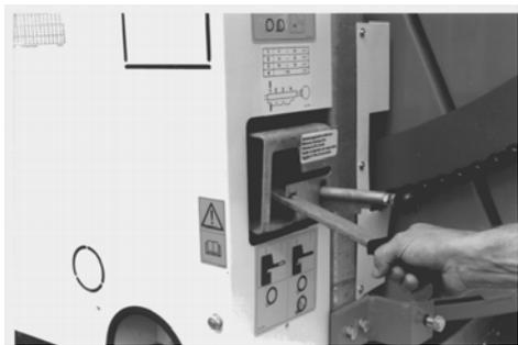
Mettez le levier d'engrenage en position „déroulement du tube PE“. Le levier est pressé vers le haut par un ressort et encliquète.
