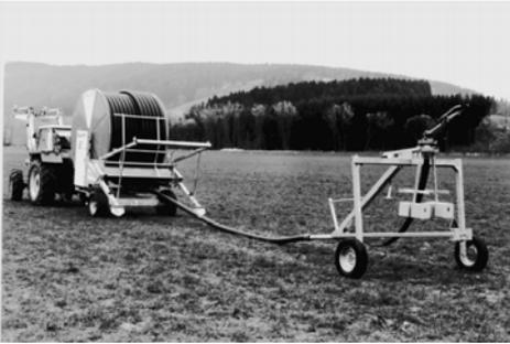
... ancrez-le légèrement dans le sol. Avancez maintenant l'appareil 2 à 3 m, levez les béquilles de support et continuez à le conduire à travers du champ.
