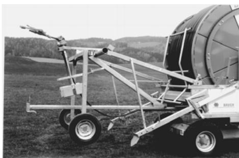
Après l'enroulement du tube PE, les béquilles peuvent être rentrées avec précaution par le système hydraulique du tracteur. Ainsi, le traîneau est levé automatiquement et mis en position de transport.
